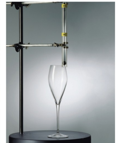
Rim impact test 杯口撞击测试
